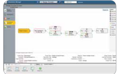
시뮬레이션 요약: CAE 작업흐름을 담아 정의하고 수집하여 정의하고 작업별 입력/출력 정보를 확인합니다.
