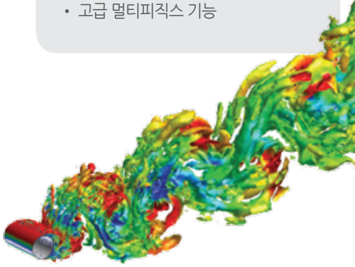
Re=140,000에서 Smooth Cylinder 위의 흐름의 Large Eddy Simulation (LES)로부터의 난류 구조의 등가면
