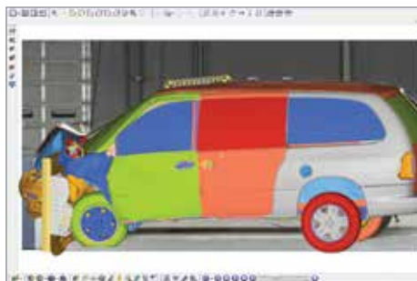
시뮬레이션 상관관계 및 offset barrier 충돌 테스트
